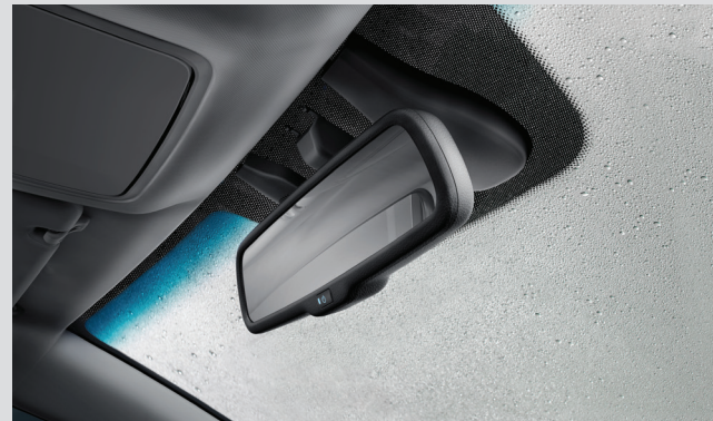
Gương chống chói ECM tích hợp la bàn Cảm biến gạt mưa tự động
